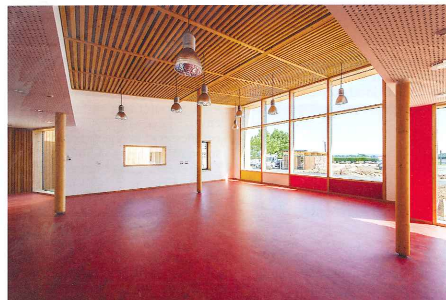
La commune d'Hadol (88), propriétaire de 1280 hectares de forêt, a choisi de valoriser son bois pour la construction du groupe scolaire. Cette réalisation de 1460 m 2 est en structure mixte bois-béton et utilise du sapin (charpente), du douglas (ossature et bardage) et du hêtre (menuiseries intérieures).
