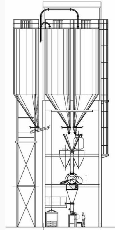
Étude de structures métalliques d'une Tour de mélange (ossatures principales et secondaires, stabilité et contreventement). Réalisation de planchers, d'escaliers et mise en sécurité de la toiture.
